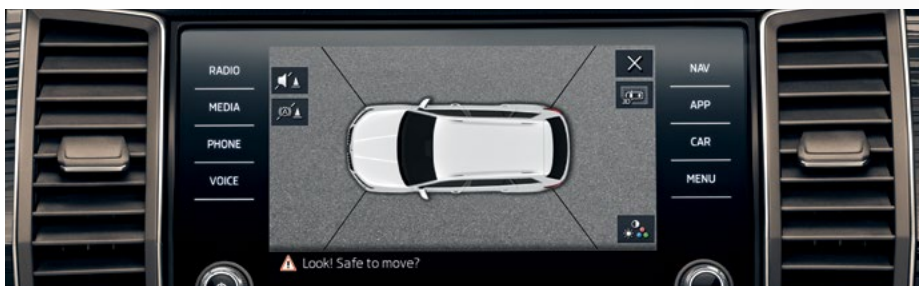
מצלמה 360° היקפית המאפשרת לראות את הרכב ע"ג מערכת השמע ממבט מעוף ציפור
