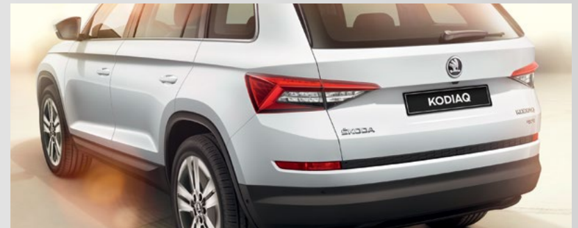
פס כורת אחורי - מוטיב עיצובי ופונקציונאלי שמטרתו להגן על הפגוש בעת הטענת
